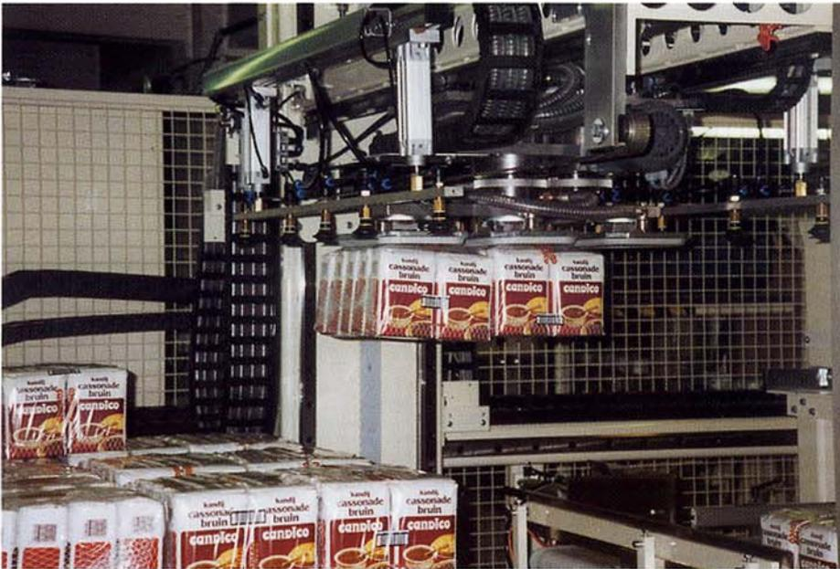
Der kompakte Roboter-Palettierer „Variomat“ beim Beladen der Paletten mit Schrumpfgewinden mit braunem Zucker.
