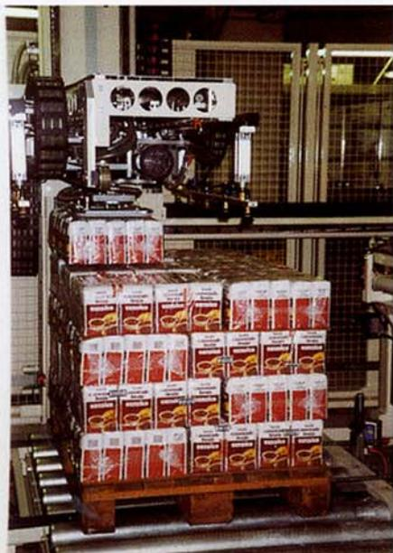
*Ablegen der nächsten Produktlage Zucker-Schrumpfpacks auf die teilbeladene Palette durch den „Variomat“-Roboter.*
