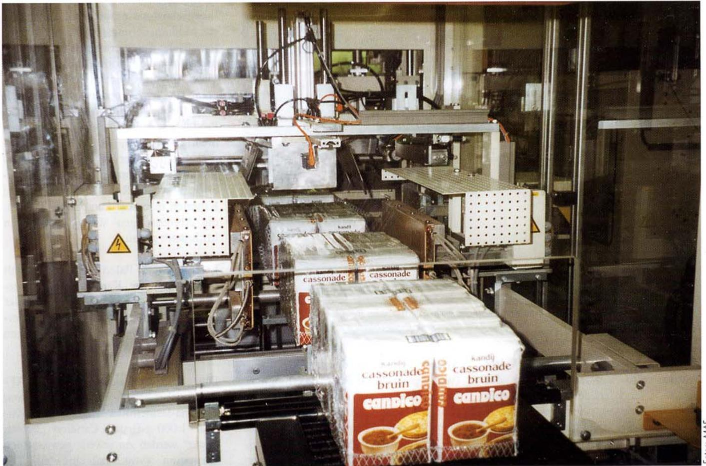
Auslaufseite des MAF-Straffpackers im Einsatz bei Candico. Im nächsten Schritt kommen die fertigen Schrumpfpacks zur vollautomatischen Palettierung.
